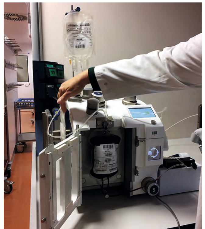
Die Blutbeutelpresse füllt die einzelnen Blutprodukte sauber voneinander getrennt ab
